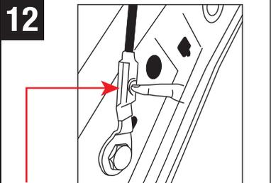
Si le câble ne s'aligne pas automatiquement et qu'il dépasse lorsque la benne est fermée, exercez une pression sur l'embout et poussez-le vers le hayon du véhicule
