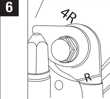
Montez d'abord le côté droit comme indiqué sur les autocollants des câbles, avant de les retirer
